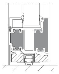
Anschlagtür, auswärts Spezialblendrahmen und Türflügelprofil umlaufend mit Absenkdichtung
